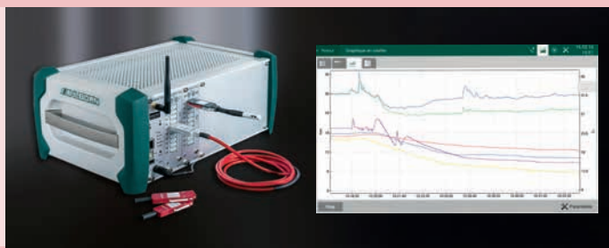
Programmation et visualisation simples des données mesurées via l'application Windows ALMEMO® 500 sur PC.
