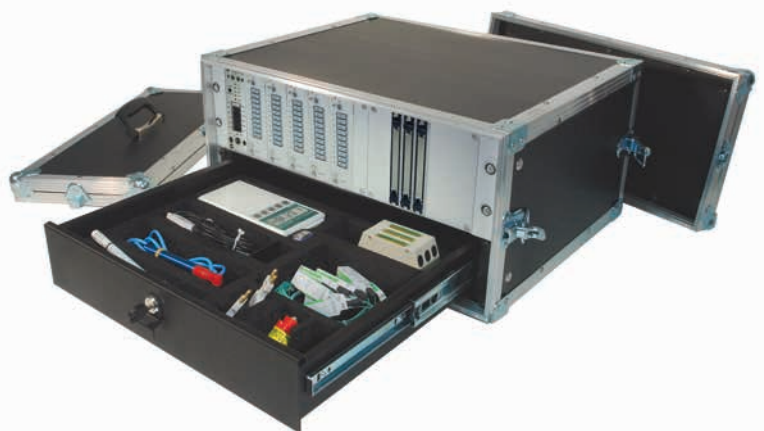
Boîtier avec poignée, ZB5090RC pour ALMEMO® 5690-xxBT8 en châssis 19"
