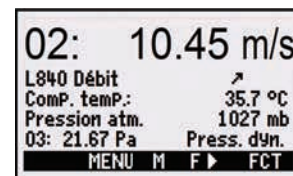
Affichage du débit, mesure automatiquement compensée en température et pression atmosphérique
