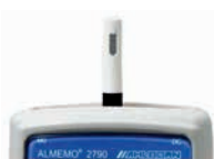
ALMEMO® 2790 avec capteur d'humidité, température, pression atmosphérique option OA 2790-RHA
