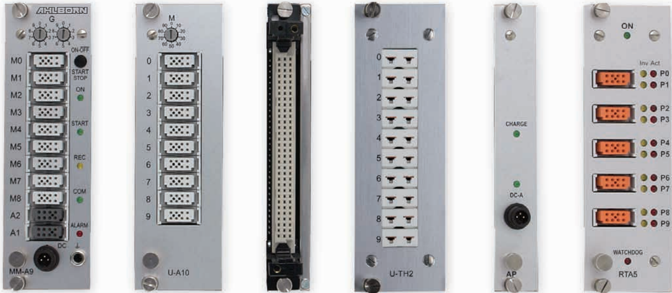
Carte de circuit de mesure maître : MM-A9
