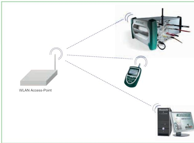
2. Connexion depuis un appareils de mesure ALMEMO® par module wifi ALMEMO® (client) sur un réseau wifi (point d'accès au réseau local d'entreprise)
