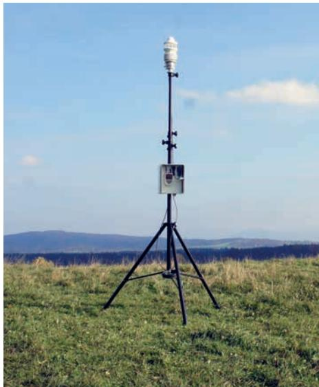
Station météorologique professionnelle à usage mobile permettant de mesurer tous les paramètres météorologiques pertinents. Facile à installer, exécution robuste, différentes centrales d'acquisition ALMEMO® V7 possibles.
