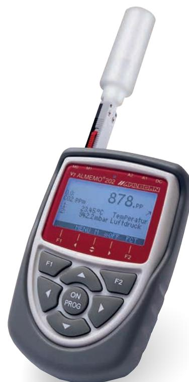
Enregistrement des valeurs mesurées de la concentration de CO<sub>2</sub> et de la température ambiante (exemple)
