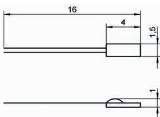
élément de capteur sans enveloppe, pour monter vos propres capteurs
