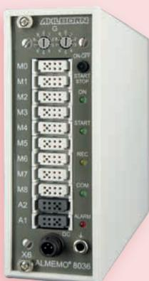
**Appareil de mesure de référence ALMEMO® pour la température et l'humidité. Appareil de mesure multicanal à 9 entrées de mesure pour capteur Pt100 et psychromètre Pt100. Mesure ultra-précise de résolution 0,001 K Pour labo d'étalonnage, assurance qualité, surveillance de chambres de mesure. Fonctionnement comme interface PC ou avec connecteur mémoire externe, comme centrale d'acquisition.**
