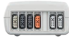
**Transmetteur analogique, 2 entrées de mesure, Double sortie analogique**
