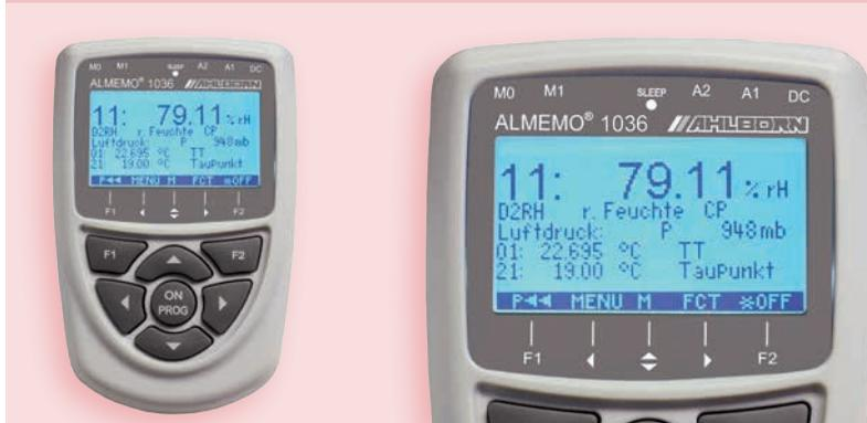
**Appareil de mesure de référence ALMEMO® de température et humidité. Mesure ultra-précise par psychromètre Pt100 et capteurs Pt100**
