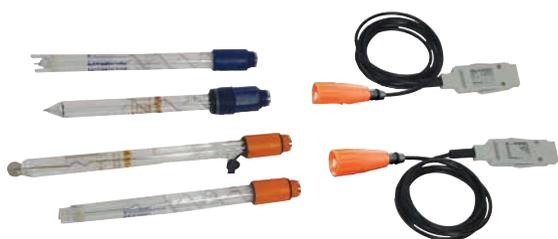
Câbles convertisseur de mesure avec différentes électrodes
