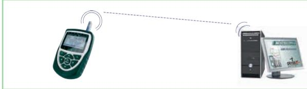
1. Connexion directe depuis un PC (client) sur un appareil de mesure ALMEMO® par module wifi ALMEMO® (point d'accès)
