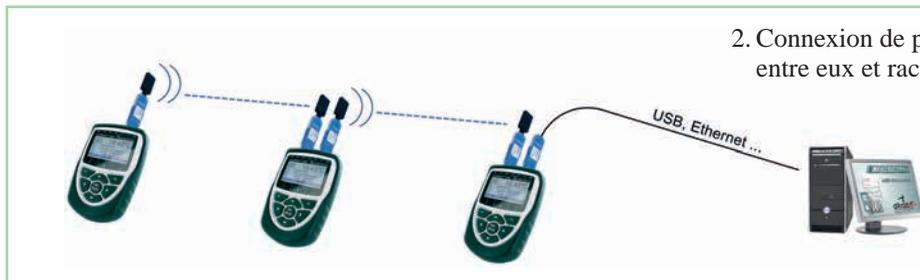
2. Connexion de plusieurs appareils de mesure ALMEMO® entre eux et raccordement filaire sur un PC
