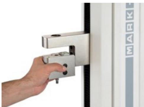
Tout en maintenant le capteur de force en place d'une main, utilisez une clé Allen de l'autre main pour serrer la vis qui relie le capteur de force à la traverse, comme indiqué ci-dessous :
