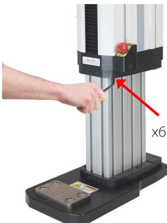
4. Positionnez le banc d'essai à la verticale et réinstallez les couvercles latéraux, comme indiqué ci-dessous :
