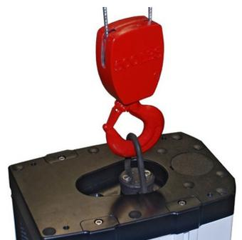
Pour les modèles F105, F305, F505 et F505H, orientez l'arrière du banc d'essai vers le bord d'une table, inclinez-le vers l'arrière, puis soulevez-le sous la base et sous l'arrière de la colonne.
