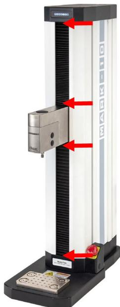
2. À l'aide d'un pinceau, appliquez une petite quantité de graisse pour roulements à usage général sur la vis, comme indiqué sur l'image ci-dessous :
