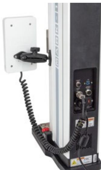
Le panneau de commande démarre automatiquement lorsque le banc de test est sous tension. L'alimentation est indiquée lorsque le logo Mark-10 en haut de la colonne est allumé.
