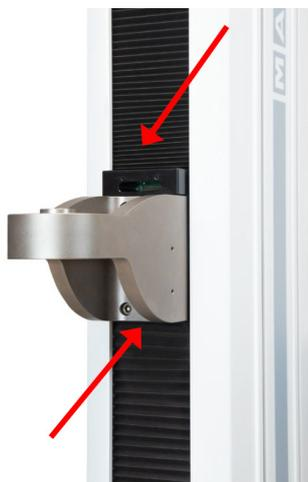
2. À l'aide d'un pinceau, appliquez une petite quantité de graisse pour roulements à usage général sur la vis, comme indiqué sur l'image ci-dessous :
