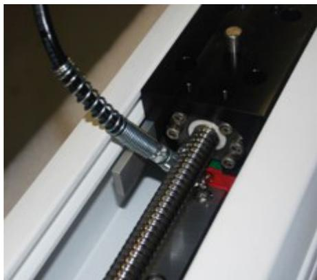
5. Faites tourner la traverse de haut en bas plusieurs fois jusqu'à ce que la graisse nouvellement appliquée soit répartie uniformément sur toute la longueur de la glissière.
