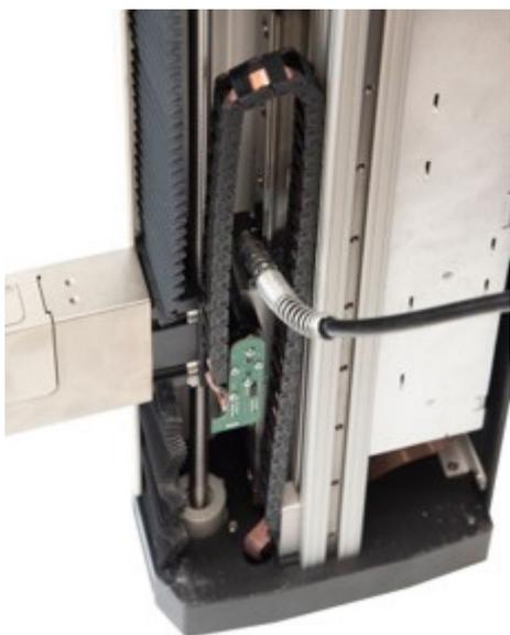
7. Faites tourner la traverse de haut en bas plusieurs fois jusqu'à ce que la graisse nouvellement appliquée soit répartie uniformément sur toute la longueur de la glissière.
