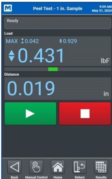
Cet exemple de vue comprend la charge et la distance, sans graphique. Soit l'option **Distance Measurement** n'est pas installée, soit la représentation graphique n'a pas été activée dans la configuration du test. Dans cet exemple, les limites de réussite/échec (Pass/Fail) ne sont pas activées.
