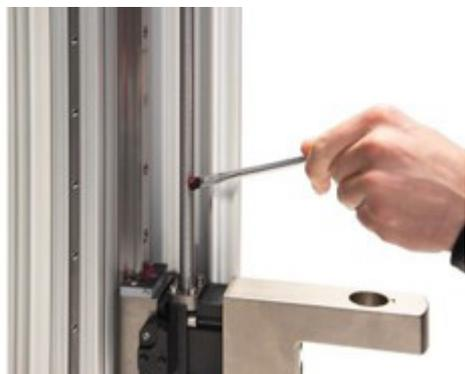
3. Faites tourner la traverse de haut en bas plusieurs fois jusqu'à ce que la graisse nouvellement appliquée soit répartie uniformément sur toute la longueur de la vis.
