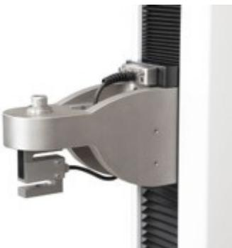
Les poignées et les fixations peuvent être vissées sur la face inférieure du capteur.
