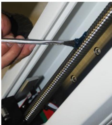
3. Faites tourner la traverse de haut en bas plusieurs fois jusqu'à ce que la graisse nouvellement appliquée soit répartie uniformément sur toute la longueur de la vis.
