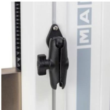
Le support de montage peut être déplacé en fonction des besoins des tests à l'aide des 2 vis fixées dans la colonne. Attention à veiller à ce que les cales soient bien en place dans la colonne pour assurer le maintien du panneau de commande et éviter tout risques de dommage ou accident.
