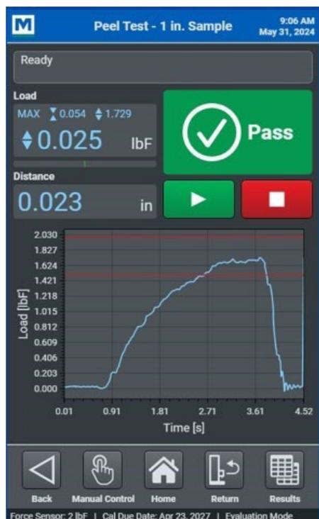
Cet exemple de vue comprend la charge, la distance, un graphique de la charge en fonction de la distance et les limites de réussite/échec (Pass/Fail) activées. L'option Distance Measurement (Mesure de distance) est installée.
