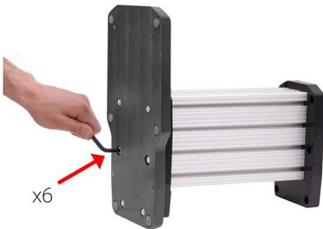
3. Fixez la bride supérieure au bas du banc d'essai à l'aide des 6 vis fournies, comme indiqué sur l'image ci-dessous :
