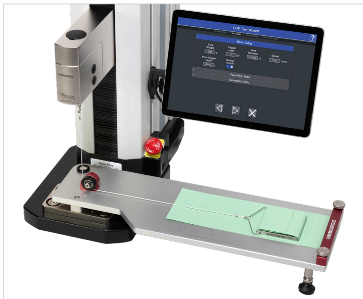
Banc de test F305-IMT configuré avec un dispositif de fixation du coefficient de friction G1086.
