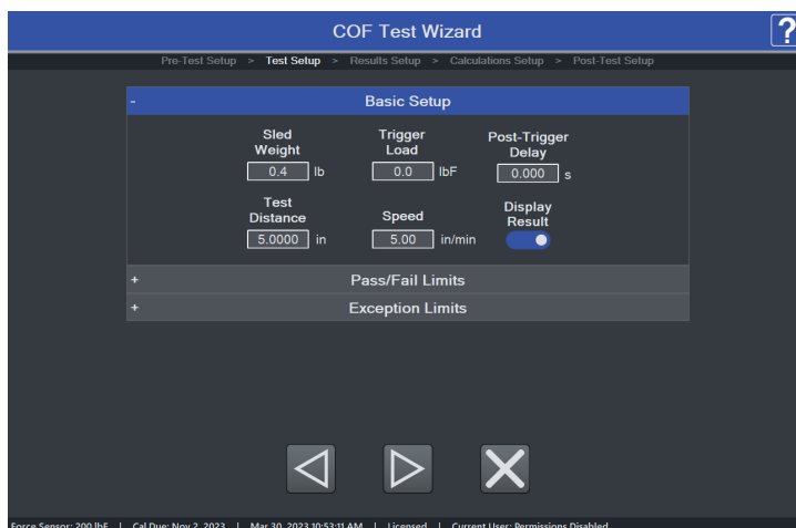
Spécifiez le poids du traîneau et les déclencheurs de démarrage et d'arrêt de la collecte de données lors de la configuration du test.
