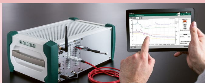
Programmation et visualisation simples des données mesurées via une tablette.
