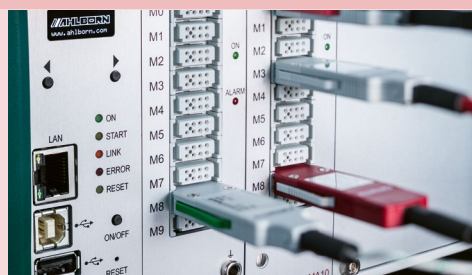
Connexions des capteurs ALMEMO® et pour la mise en réseau (témoin d'état OLED)
